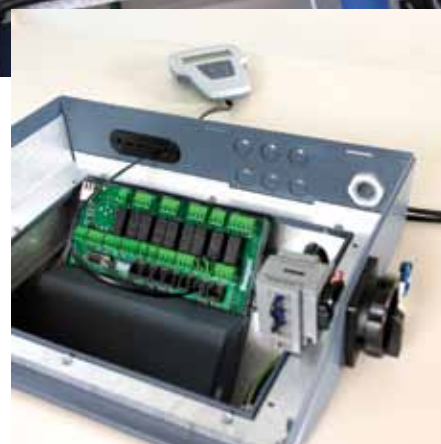
Все электро- и управляющее оборудование собрано в электрошкаф средней секции агрегата
