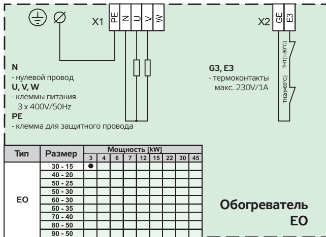
РИС. 17 – СХЕМА ПОДКЛЮЧЕНИЯ ОБОГРЕВ. EOS
