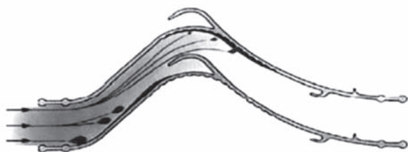
РИСУНОК 15 – ПРАВИЛЬНОЕ НАПРАВЛЕНИЕ ПЛАСТИНЫ КАПЛЕУЛОВИТЕЛЯ
