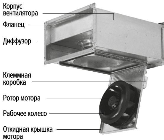
РИС. 3 – СОСТАВ ВЕНТИЛЯТОРА R0 (ОТКРЫВАЮЩИЙСЯ ТИП)
