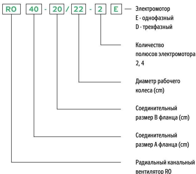
РИС. 1 – ТИПОВОЙ КЛЮЧ ДЛЯ ОБОЗНАЧЕНИЯ ВЕНТИЛЯТОРОВ RO
