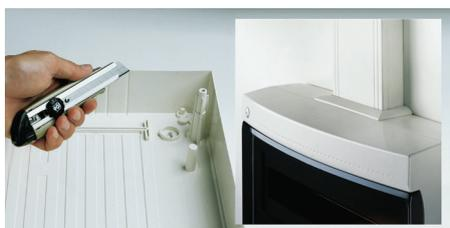
Насечки на внутренней стороне настенных щитков обеспечивают соединение с пластиковыми коробами ДКС системы "In-liner" с помощью специального переходника. Возможно использование короба глубиной 60 и 80 мм, шириной от 60 до 200 мм, при этом обеспечивается точность и эстетичность соединения.
