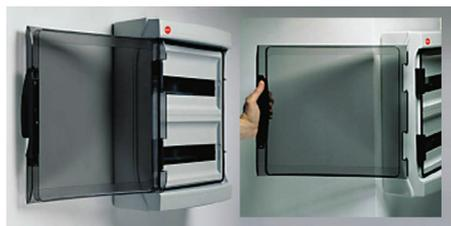
Специальная конструкция петель дает возможность открывать дверцу более чем на 180°, защищая ее от повреждений при случайном ударе. Для снятия дверцы достаточно полностью открыть ее и нажать на ручку. Операция не повлияет на функциональность шарнирного соединения.
